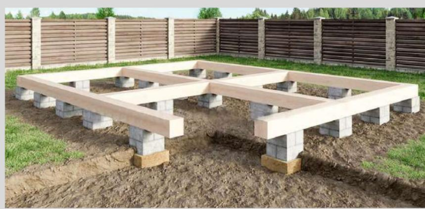
Для загородных домов рекомендуют устанавливать столбчатый фундамент с ростверком – это монолитная плита или каркас, которые скрепляют столбы сверху, придают больше прочности и жесткости данной конструкции.
