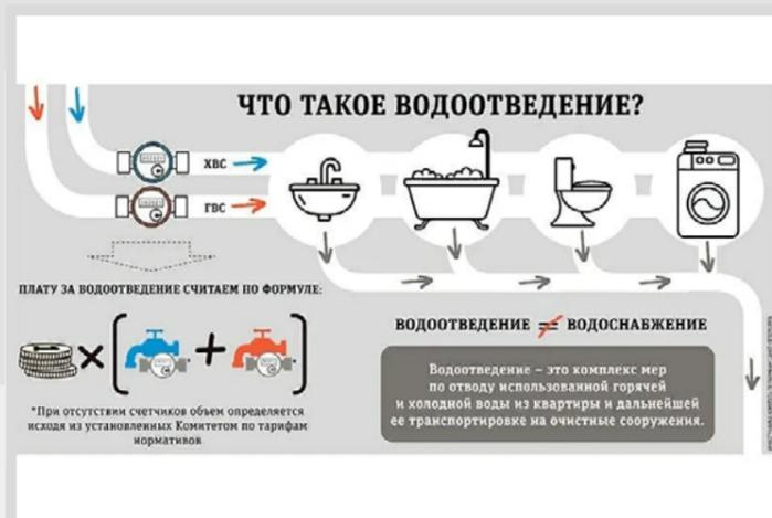
Централизованная система водоотведения - комплекс инженерных сооружений населенных пунктов для сбора, очистки и отведения сточных вод в водные объекты и обработки осадков сточных вод.
