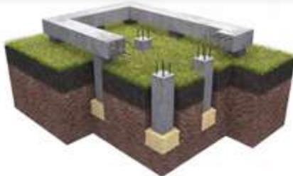
Для загородных домов рекомендуют устанавливать столбчатый фундамент с ростверком. Это монолитная плита или каркас, который скрепляет столбы сверху, придает больше прочности и жесткости данной конструкции.
