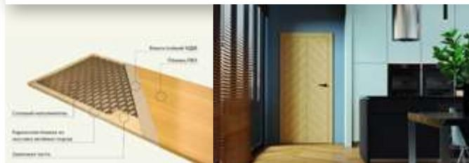
Шпонированная - значит облагороженная шпоном - тонким листом натуральной древесины. Конкретно в дверном производстве используют лущеный и строганный шпон толщиной до 0,6 мм, снятый с ценных пород: дуба, абачи, ореха, венге, красного дерева и т. д.
