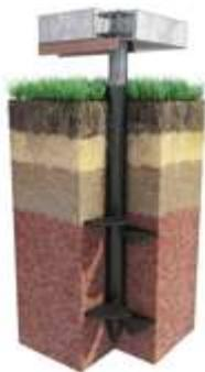
Свайно-винтовой фундамент - это основа для дома из стальных свай, которые вкручиваются в землю и соединяются ростверком. Винтовая свая - это элемент быстровозводимого фундамента, погружаемый в практически любой грунт. Такие сваи производятся из стальной трубы различного диаметра со специальными лопастями для ввинчивания в массив как вручную, так и специальными машинами. (толщина металла - не менее 3мм, лопастей - не менее 4мм.).
