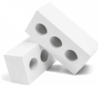
Кирпич силикатный – это искусственный безобжиговый стеновой материал, основу которого составляют известь, песок и вода. Смесь данных компонентов прессуется, затем в процессе автоклавирования под действием пара, высокого давления и температуры приобретает твердость и прочность.
