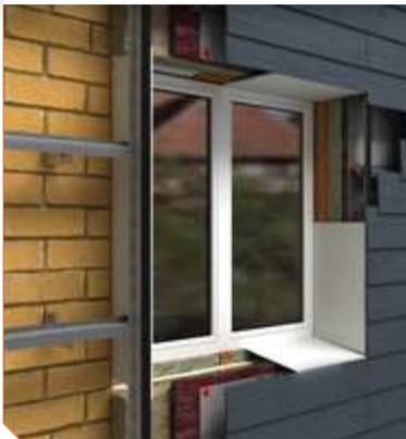
Фибросайдинг, или фиброцементные панели, — это наружный облицовочный композитный материал. В основе этих листов — цемент, усиленный армирующим фиброволокном с минеральными или целлюлозными добавками. Крепятся они по технологии вентилируемого фасада поверх обрешетки. Возможен монтаж на металлический или деревянный каркас, в зависимости от выбранного типа системы.
