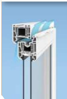
Основа системы — термоцилиндр, заполненный парафином, он соединен с рамой. При температуре выше 23 °C парафин нагревается и расширяется, при этом создается давление, которое действует на телескопические штыри, приоткрывая систему. Образуются щели между рамой и стеклом, и через них поступает воздух. При понижении температуры в помещении охлаждается и парафин, его объем становится меньше и механизм закрывается.
