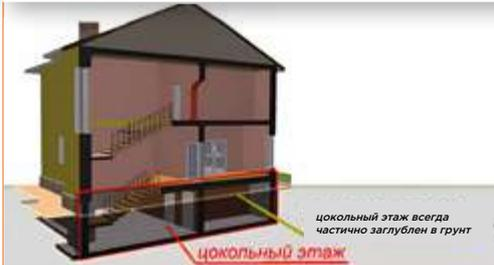
Цокольный этаж - это эксплуатируемое помещение с возможностью доступа, используемое для временного или постоянного пребывания людей, отметка пола которого расположена ниже уровня земли вокруг здания. Высота цокольного этажа не должна быть менее 2,5 метров (чтобы считаться этажом), а над землей он может возвышаться не более чем на метр.
