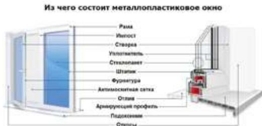
Металлопластиковые окна - это современные светопрозрачные конструкции из ПВХ-профиля с армированием, обеспечивающим необходимую прочность и жесткость изделия.
