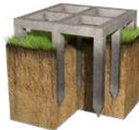
Железобетонный забивной фундамент — это надежное основание для тяжелых сооружений, которые создают большую нагрузку на почву. Железобетонные сваи для фундамента — это стержни с квадратной или круглой формой сечения и заостренным нижним концом. Наиболее распространенными являются квадратные сваи с размером стороны от 200 до 400 мм и длиной от 3 до 28 м.
