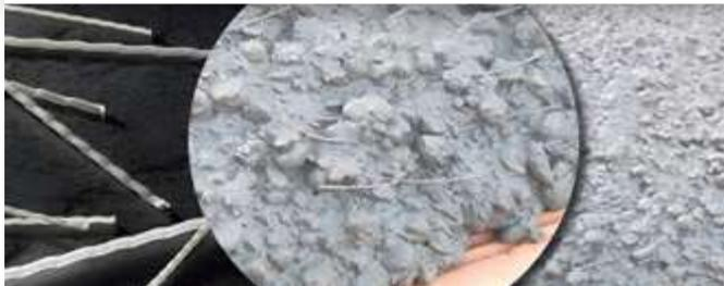
Прочность бетона зависит от качества заполнителя (щебня, гравия), от качества цемента и качества цементного камня. Прочность бетона выше, если прочнее заполнители. Чем выше марка цемента, тем при других равных условиях прочнее будет цементный камень.
