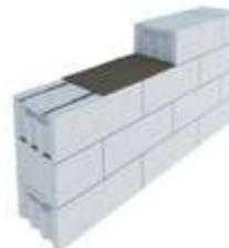
Правильный газоблок производится из разновидности ячеистого бетона - газобетона. Без посторонних примесей. Он состоит из обычного цементного раствора, песка и воды с добавлением алюминиевой пудры, которая и образует газообразование (выделяя водород).
