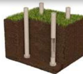
Буронабивными сваями называют разновидность опор, которые применяют для монтажа фундаментов. Для установки опорного столба бурят скважину, в нее опускают обсадную трубу, армокаркас и заливают бетонной смесью.
