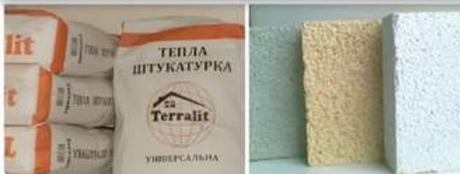
Теплая штукатурка - это смесь, предназначенная для наружной и внутренней теплоизоляции. В состав такой смеси обычно входят цементный раствор и специальный наполнитель. В качестве наполнителя для теплой штукатурки используют опилки, перлит, вермикулит, пенополистирол, пеностекло.
