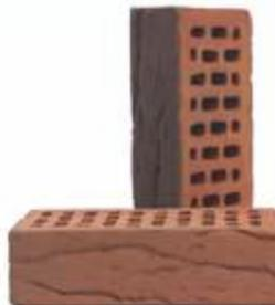
Клинкерный кирпич – самый прочный и износостойкий строительный и отделочный материал с неограниченным сроком службы. Производится из особых пород глины при обжиге 1300 градусов.
