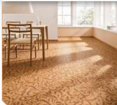
Пробковое покрытие - это напольное покрытие, которое изготавливается из коры пробкового дуба. Основная часть плантаций пробковых дубов сосредоточена в Португалии. Верхний слой пробкового пола - пробковый шпон, который определяет внешнюю привлекательность покрытия.
