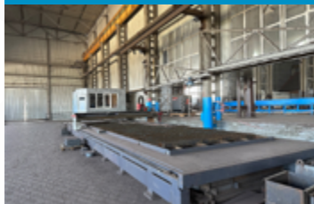
ДВА СТАНКА ПЛАЗМЕННОЙ РЕЗКИ РАМЕРАМИ 12Х3М HPR260XD
